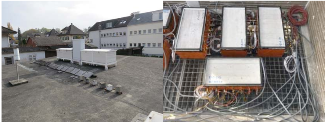
Abb.27 Stevenson-Screens auf dem Garagendach der TFB AG in Wildegg für die unbewitterte Aussenlagerung von Prüfkörpern und dazwischen der Schrank für das Monitoring (links) und im Stevenson-Screen eingelagerte Prüfkörper (rechts).
